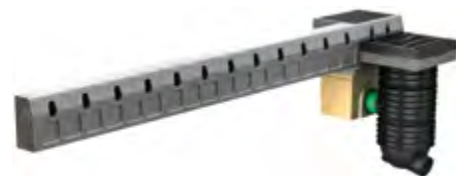
ACO Drain®Box City: Die Linien- und Punktentwässerung kombiniert die Hohlbordrinne KerbDrain mit dem Straßenablauf Combipoint PP
